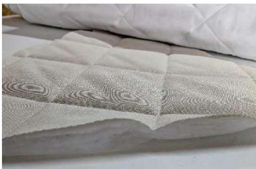
Nous proposons la bulle ossature bois en **version isolée** à l'aide d'un multicouche souple composé de 3 couches de ouate et 2 couches de tissu.
