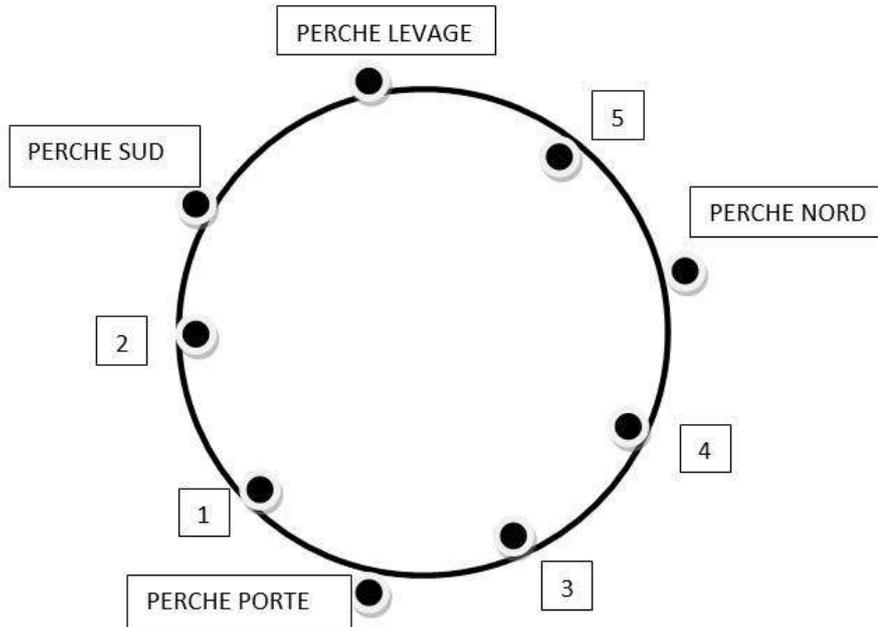
**Annexe 2** : emplacement des 12 perches pour un diamètre 5m et 5.5m (12 perches + 2 ext.)
