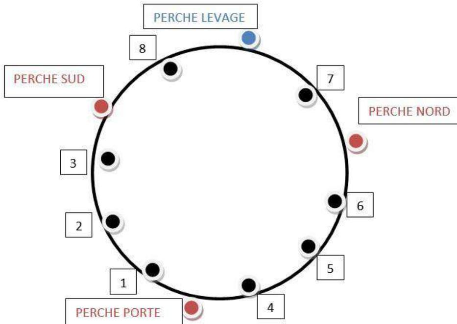
**Annexe 3** : emplacement des perches pour un diamètre 6m (15 perches + 2 ext.)
